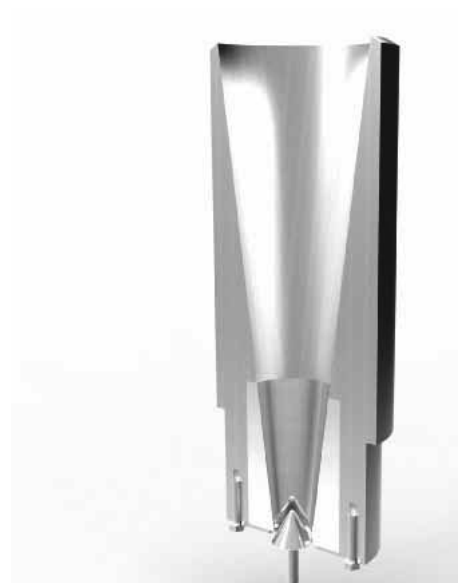
Hydrozyklon mit Abscheider. Er kann Feststoffpartikel aus Suspensionen abtrennen oder Suspensionen wie Öl-Wasser-Gemische trennen. Hartmetall an den neuralgischen Stellen setzte den andauernden Störungen ein Ende.
